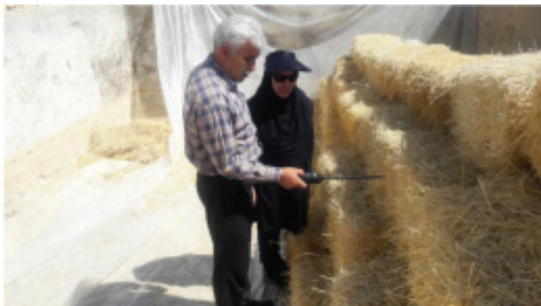
شکل ۸- اندازه‌گیری رطوبت پشته با رطوبت‌سنج
