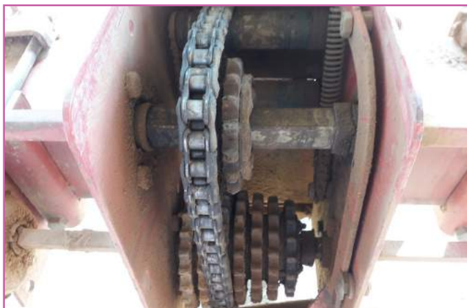
شکل ۵- با تغییر چرخ دنده‌های جعبه دنده می‌توان فاصله بین بذرها را تنظیم کرد
