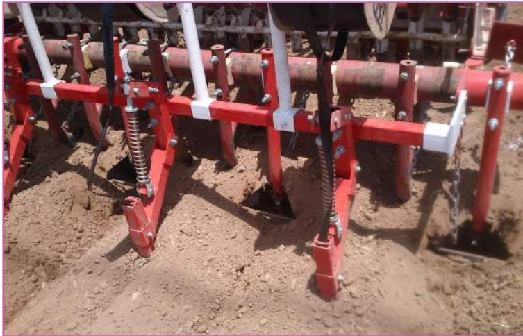
شکل ۳- امکان پخش نوار تیپ به روش مکانیزه هم‌زمان با عملیات کاشت
