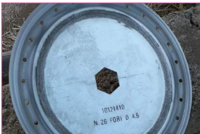
شکل ۶- موزع مورد استفاده برای ارقام متداول لوبیا (تعداد سوراخ‌ها ۲۶ عدد با قطر ۴/۵ میلی‌متر)
