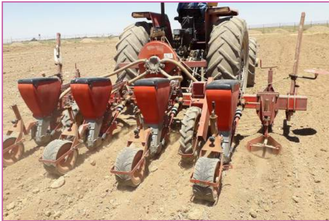
شکل ۴- کشت لوبیا با استفاده از ردیف‌کار پنوماتیکی با آرایش یک ردیف روی پشته و فاصله ۷۵ سانتی‌متر بین پشته‌ها
