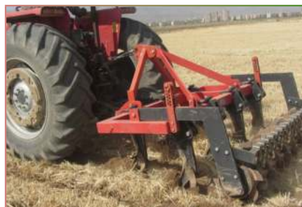
شکل ۷- ادوات کم‌خاک‌ورزی: گاواهن چیزل‌پکر (سمت راست) و گاواهن مرکب (سمت چپ)
