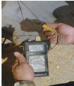
شکل ۴ الف- نمای کوره طراحی شده برای تهیه خاکستر پوسته شلتوک ب- نحوه کنترل درجه حرارت کوره با باز و بسته کردن دریچه فوقانی و تحتانی و ج- نحوه اندازه گیری درجه حرارت کوره به وسیله ترموکوپل
