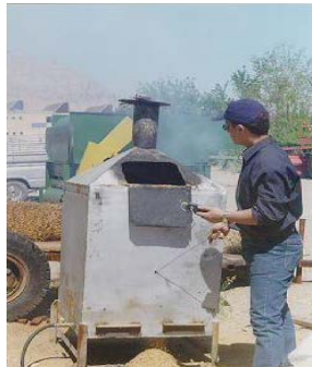
شکل ۴ الف- نمای کوره طراحی شده برای تهیه خاکستر پوسته شلتوک ب- نحوه کنترل درجه حرارت کوره با باز و بسته کردن دریچه فوقانی و تحتانی و ج- نحوه اندازه گیری درجه حرارت کوره به وسیله ترموکوپل
