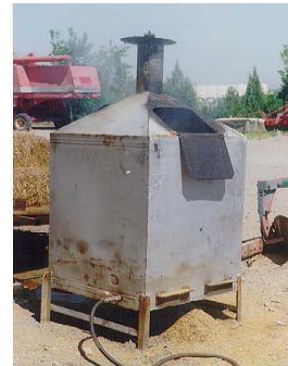
شکل ۴ الف- نمای کوره طراحی شده برای تهیه خاکستر پوسته شلتوک ب- نحوه کنترل درجه حرارت کوره با باز و بسته کردن دریچه فوقانی و تحتانی و ج- نحوه اندازه گیری درجه حرارت کوره به وسیله ترموکوپل
